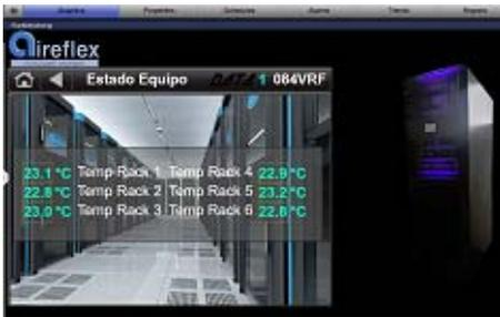
•**Sistemas con el módulo economizador Free Cooling (FC):** A través del sistema de monitoreo se puede consultar las condiciones de Temperatura de Retorno y de Aire Exterior así como el ahorro de energía alcanzado.
